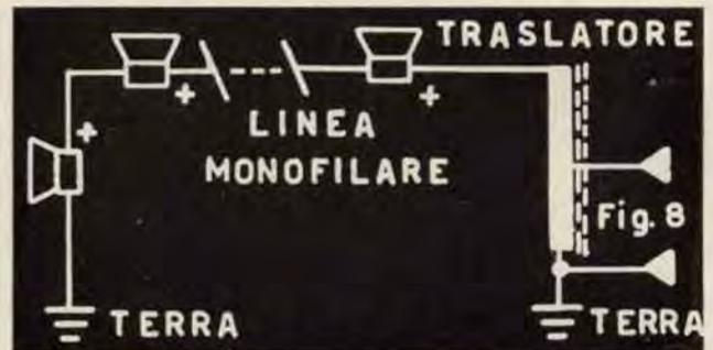
... nel caso si possa usufruire di una presa di terra all'entrata e all'uscita della linea e la potenza da distribuire possa essere frazionata in parti uguali mediante collegamento in serie.
