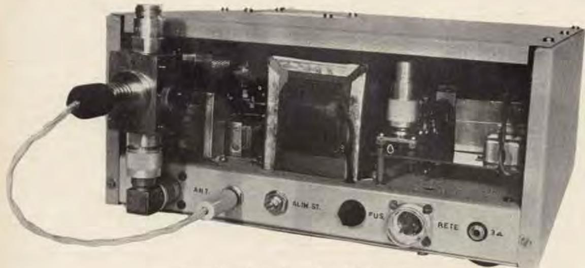
L'accoppiatore direzionale montato sul ricetrasmittitore.
