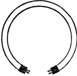
Fig. 8. — Tube fluorescent de forme circulaire.
