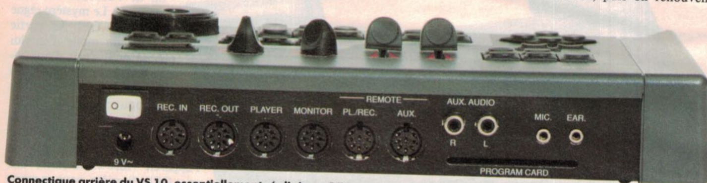
Connectique arrière du VS 10, essentiellement réalisée en DIN.
