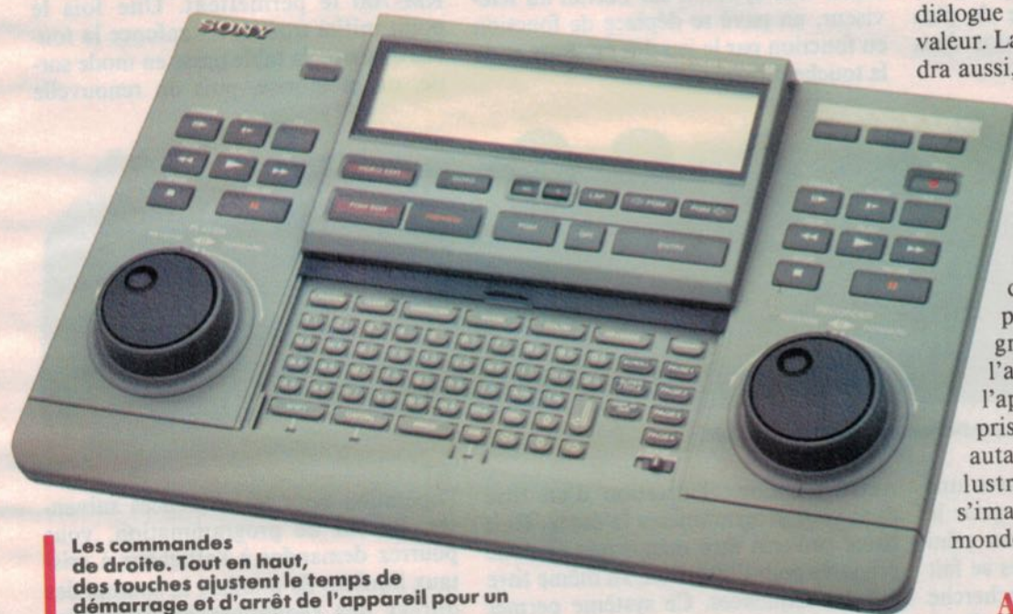
La façade est divisée en surfaces fonctionnelles : commandes des machines avec molette de recherche, son et gestion du montage par l'intermédiaire du menu.
