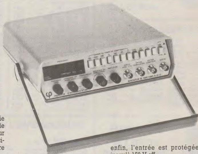
Avec un affichage sur 6 digits avec possibilité de dépassement pour obtenir une meilleure résolution, il mesure les fréquences allant de 10 Hz à 1 000 Hz avec une sensibilité d'entrée de 25 mV (10 Hz - 10 MHz) ou de 50 mV (10 MHz - 100 MHz). Le temps de porte sélectionnable de 0,01 s à 10 s et,
