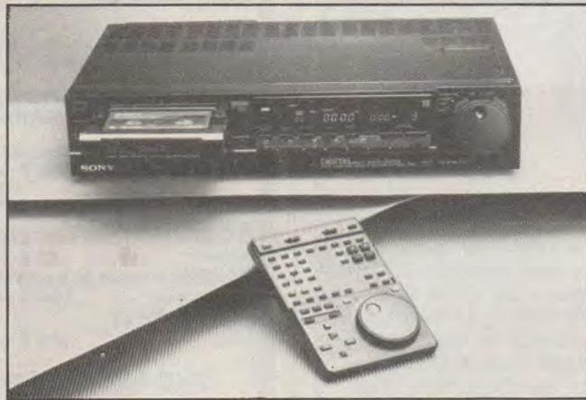
La molette de recherche d'images permet de changer la vitesse de lecture lente ou rapide, avant ou arrière, et l'arrêt sur image. Il est donc facile en cas de montage de déterminer le point de départ et de fin de
