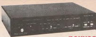
**AEA - PK 232C.** Contrôleur de Packet Radio. Programme de communication interne 300, 1200, 2400, 4800 et 9600 bauds. Décodage et protocole pour CW, RTTY (Baudot et ASCII), AMTOR, PACKET. HF et VHF. Modem VHF/HF/CW. Bande passante automatique.
