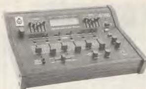
TDM 1000. 7 entrées avec pré-réglages de niveaux dont 6 stéréo et 1 entrée micro. Echo électronique reverb. 30-200 ms. Equaliseur 2 x 5 fréq. Réglage master.
