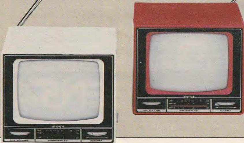
Le Tensaï TNB 512 est un mini-téléviseur noir et blanc dont le tube cathodique présente une diagonale de 12 cm. Outre l'antenne télescopique, une prise d'antenne extérieure est prévue. Le TNB 512 reçoit les canaux VHF ABC 1 à 6 et VHF 21 à 69 en Secam LL'. La section audio délivre 0,8 W avec 10 % de THD et la consommation électrique ne dépasse pas 10 W.
