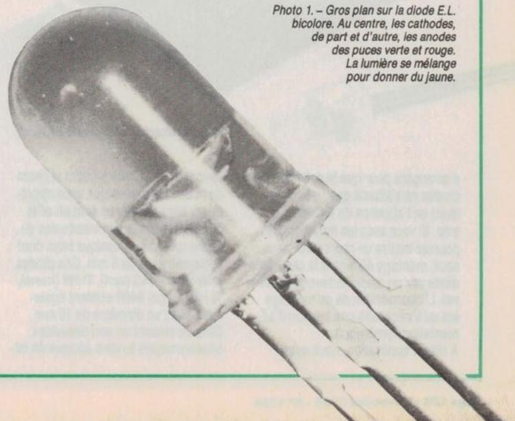
Photo 1. - Gros plan sur la diode E.L. bicolore. Au centre, les cathodes, de part et d'autre, les anodes des puces verte et rouge. La lumière se mélange pour donner du jaune.
