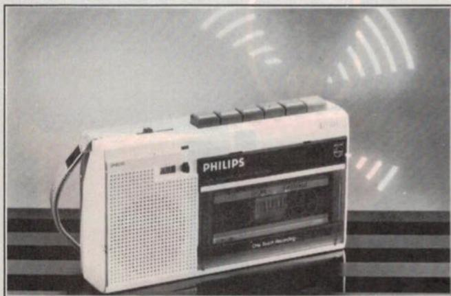
Le magnétophone Philips D 6270 est un appareil « intelligent » qui déclenche et arrête automatiquement l'enregistrement.
