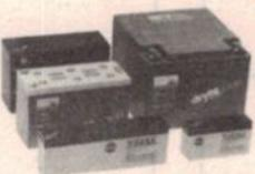
**BATTERIES :** Accumulateurs au plomb, gélifié sans entretien. Durée moyenne de vie : 5 à 7 ans. 1,2 Ah 6 V - 1,9 Ah 12 V - 6 Ah 12 V - 24 Ah 12 V - 36 Ah 12 V.
