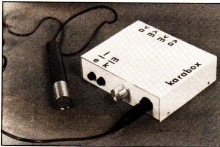
le seul mal que peut faire notre fée Karabox. aussi d'Autriche). Cet adaptateur dispose d'un préamplificateur micro, à gain variable, qui pourra aussi traiter un signal provenant d'un instrument de musique électronique, clavier, par exemple. Notre adaptateur se branche sur la prise magnétophone de l'amplificateur, mais possède deux prises identiques de façon à accueillir le magnétophone spolié. C'est là
