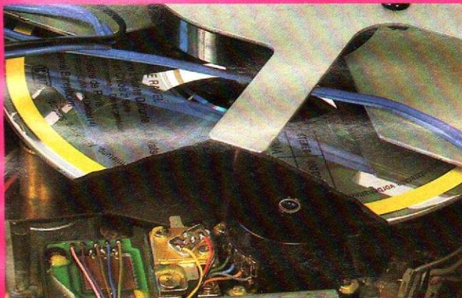
Photo 3. - La tête laser à son emplacement de lecture. Son capot a été enlevé pour laisser apparaître, à gauche de l'objectif, le laser, puis le détecteur photoélectrique.
