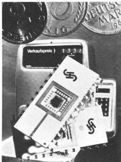
Fig. 5. — Circuit MOS pour affichage automatique des prix sur balance (Siemens).
