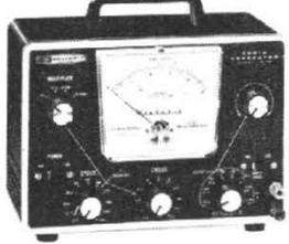
Générateur BF IG-72E Sélection des fréquences par affichage - 10 Hz à 100 kHz - Taux de distorsion inférieur à 0,1% - Galvanomètre gradué en volts et en dB - Atténuateur par pas de 10 dB.
