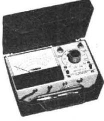
Voltmètre Electronique Transistorisé IM-17G Circuit d'entrée haute impédance 11 M  $\Omega$  en CC - Transistors FET - Alimenté par piles - 0-1 à 0-1000 volts en CA et CC - Ohmmètre de 0,1  $\Omega$  à 1000 M  $\Omega$
