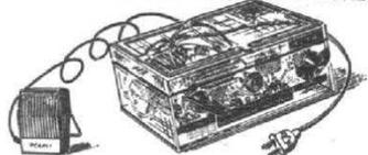
Le Télécophone TLT.4 se dispose tout simplement auprès de la sonnette d'un téléphone. Sur réception d'un coup de sonnerie, un relais s'enclenche et s'arrête au bout d'un certain temps, que l'on peut régler jusqu'à quelques minutes. En exemple d'application, on peut à distance allumer la lumière d'un appartement vide pour simuler une présence, ou mettre en route divers appareils. Utilisé également en antivol, l'appareil peut déclencher une alarme sur réception d'un bruit quelconque.
