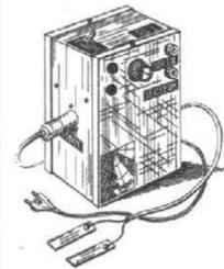
des métalliques pouvant être disposées en tout lieu de surveillance. Mises dans un réservoir, l'appareil déclenche dès que le liquide atteint (ou quitte) les sondes. Mises dans le sol, l'appareil déclenche pour un certain niveau de sécheresse. Il se termine par un relais qui peut actionner une valvaine, un moteur, une alarme... Nombreuses applications possibles.
