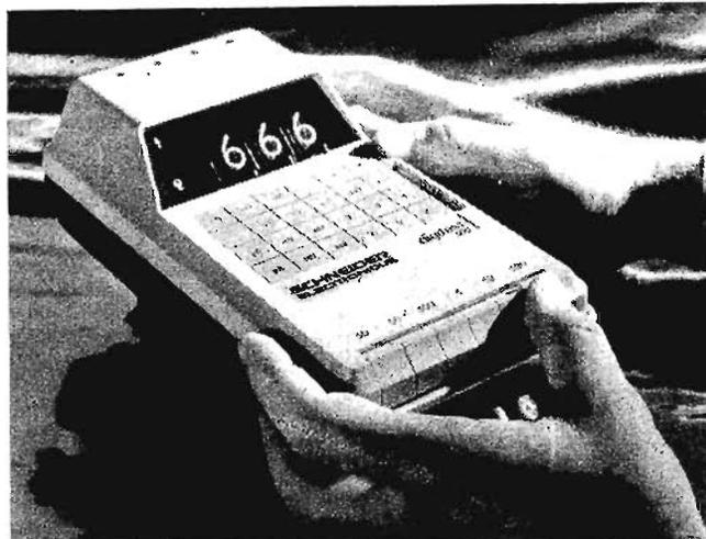
FIG. 3. — Le multimètre numérique Digitest 500 « Schneider RT ».
