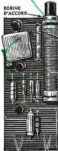
Ce module alimenté par une petite pile de 9 volts permet, à l'aide d'un poste récepteur-radio classique réglé sur la gamme des P.O. (1 500-1 600 Kcs) une liaison radio audible dans l'enceinte de votre appartement.
