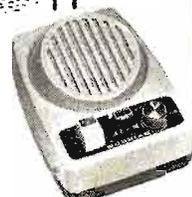
en restant dans les limites d'une même propriété (Règlement P. et T.) vous pouvez correspondre jusqu'à 3 kilomètres de distance, en branchant deux ou plusieurs interphones RAINBOW sur les prises de courant d'un même réseau 110 ou 220 volts. La liaison phonique s'effectue le long des fils E.D.F. par superposition de la parole sur le courant du secteur. FINI... les installations fixes et onéreuses, chaque appareil peut être déplacé à volonté d'une prise de courant à une autre.
