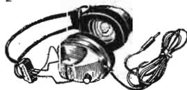
**Casque DH04S** : casque stéréophonique à deux écouteurs réglables, chaque écouteur étant muni d'un tweeter et d'un potentiomètre de réglage de tonalité. Bande passante : 20 à 20 000 Hz. Impédance : 4, 8, 16 ohms. Sensibilité : 105 dB-1 mW. Puissance : 0,25 W. Muni d'un câble et d'un jack de branchement. Poids : 370 g.
