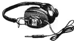
**Casque DH03S** : il s'agit également d'un modèle stéréophonique à 2 écouteurs réglables, 4, 8 et 16 ohms. Bande passante : 20 à 18 000 Hz. Puissance : 0,3 W. Sensibilité : 108 dB-1 mW. Muni d'un câble et d'un jack de branchement. Poids : 350 g.
