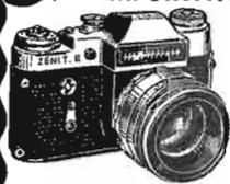
Un reflex mono-objectif 24x36. Cellule photo-électrique incorporée mais non couplée. Miroir à retour éclair. Obturateur rideau 6 vitesses : de la pose B au 1/500<sup>e</sup> de sec. Objectif Hélios 44 - 6 lentilles - Ouverture 2 - F : 58 mm - Monture 42 mm à vis - Bague de diaphragme présélective - Retardement de 9 à 15 sec. - Synchronisation FP/X - Mise au point sur dépoli - Griffe porte-flash.
