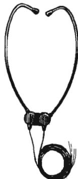
peuvent être utilisés pour l'écoute BF ou pour d'autres applications. Le modèle SF3000 de  $2 \times 100$  kohms à haute impédance comprend deux écouteurs sur dispersers. Il fonctionne en monophonie et en stéréophonie. Il est possible de raccorder les deux fils de sortie en série ( $Z = 200$  kohms) ou en parallèle ( $Z = 50$  kohms). Poids : 45 g.
