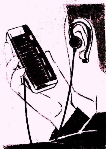
Fig. 4. — Boîtier de commande à distance par câble avec prise pour récepteur téléphonique (Ténac)
