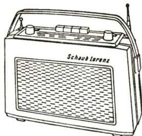
9 transistors + 4 diodes - 3 gammes PO, GO, modulation de fréquence - 2 antennes télescopiques pour modulation de fréquence - Prise antenne auto commutée - Haut-parleur 9 x 15 - Puissance 1 W - Contrôle de tonalité graves et aiguës séparés - Couleurs : anthracite, gris tourterelle, vert, sable - Dimensions : hauteur 175 ; largeur 270 ; profondeur 80 - Poids : 2 kg. environ.
