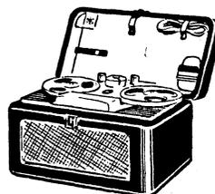
Magnétophone à défilement de 9,5 cm double piste. Haut-parleur incorporé Livré avec microphone Piézo, une bobine pleine et une bobine vide de 12,7 cm. Secteur 110 et 220 V. Durée d'enregistrement : 1 heure sur bande normale 3 915/00 ; 1 h 30 sur bande extramince 3 915/50. Magnétophone de haute qualité musicale, d'emploi très simple, permettant d'enregistrer sur bande magnétique des sons de toute nature et de les reproduire instantanément. Dimensions : 350x250x190. Poids : 10 kgs.
