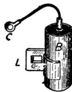
Fig. 7. — Condensateur d'antiparasitage : B, boîtier métallique ; L, languette de fixation peccée d'une lumière formant électrode à la masse ; C, cosse de la connexion isolée.
