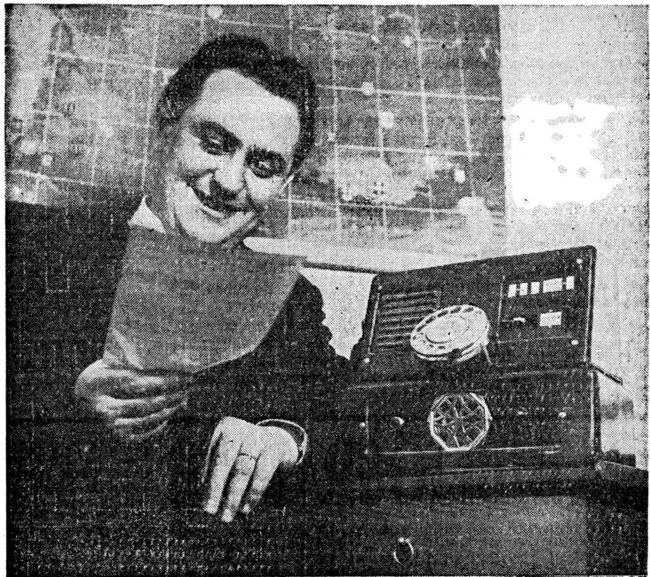
Figure 1. — Le Néophone remplace avantageusement le combiné téléphonique par un haut-parleur et un microphone permettant d'écouter et de parler à distance de l'appareil.
