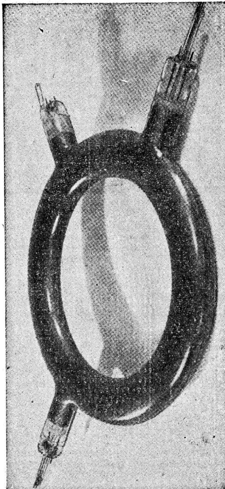
La chambre annulaire du bétatron suisse qui correspond au « Donut » du bétatron américain. Elle comporte deux injecteurs d'électrons, à droite et à gauche, la troisième tubulure contient un « getter » qui, chauffé en permanence, absorbe les gaz résiduels. Cette chambre en verre soufflé doit supporter une pression de 7 tonnes.
