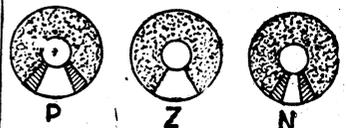
Fig. 2. — Diagramme sur le tube 6E5 avec circuit à réponse polarisée : P, signal positif ; Z, signal nul ; N, signal négatif.
