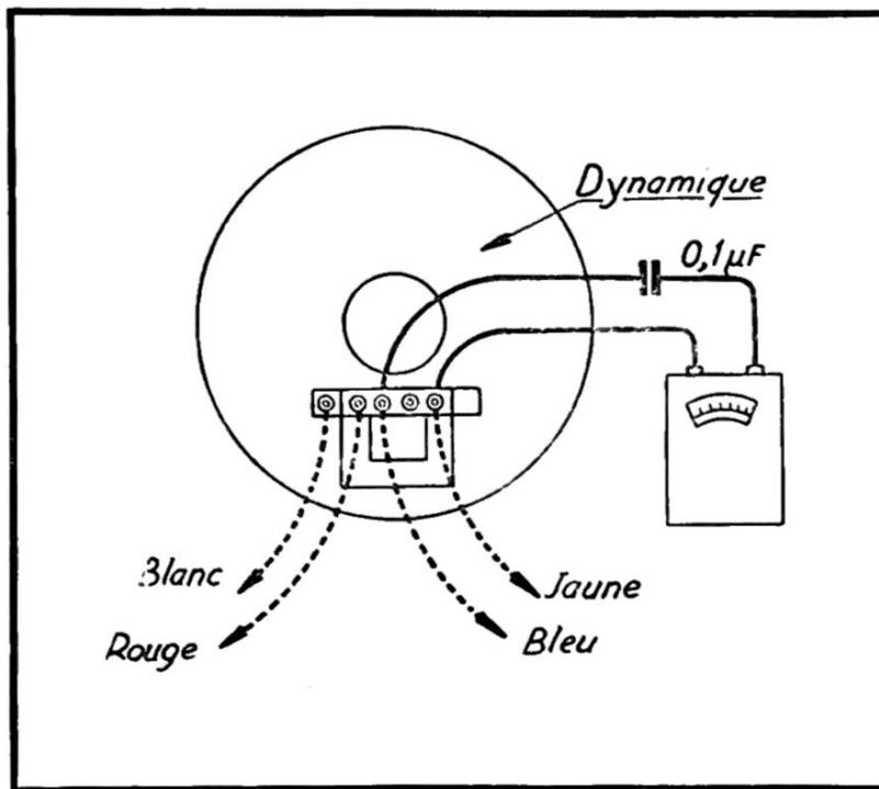
versel, genre Chauvin-Arnoux, en ayant soin de placer le bouton-poussoir de celui-ci sur la position alternatif et en intercalant une capacité de l'ordre de 0,1  $\mu$ F. (Voir schéma ci-contre.)
