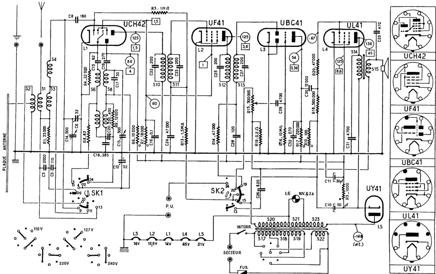
Schéma général des récepteurs BF321A et RA352A.
