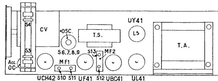
L'alimentation des tubes en haute tension est assurée par l'enroulement secondaire du transformateur d'alimentation ( $S_{20} + S_{21} + S_{23}$ ) suivi d'une valve monoplaque UY41.
