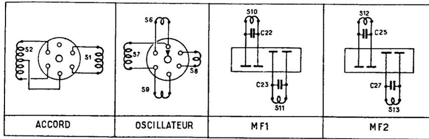
Branchement des bobinages des récepteurs BF321A et RA352A.
