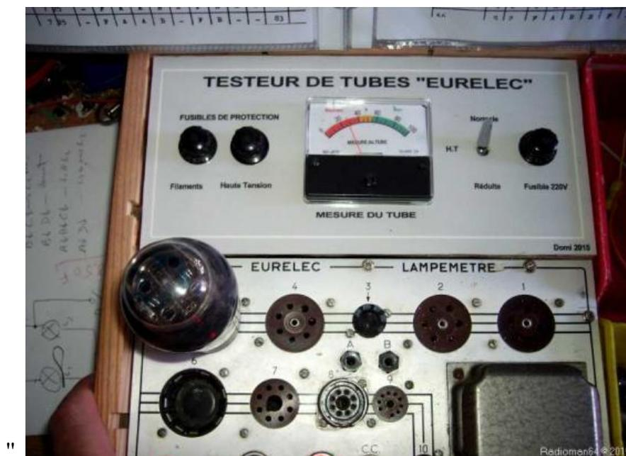
Il s'agit d'un tube type "47" provenant d'un poste des années 30: le résultat est très net: la lampe est épuisée!
