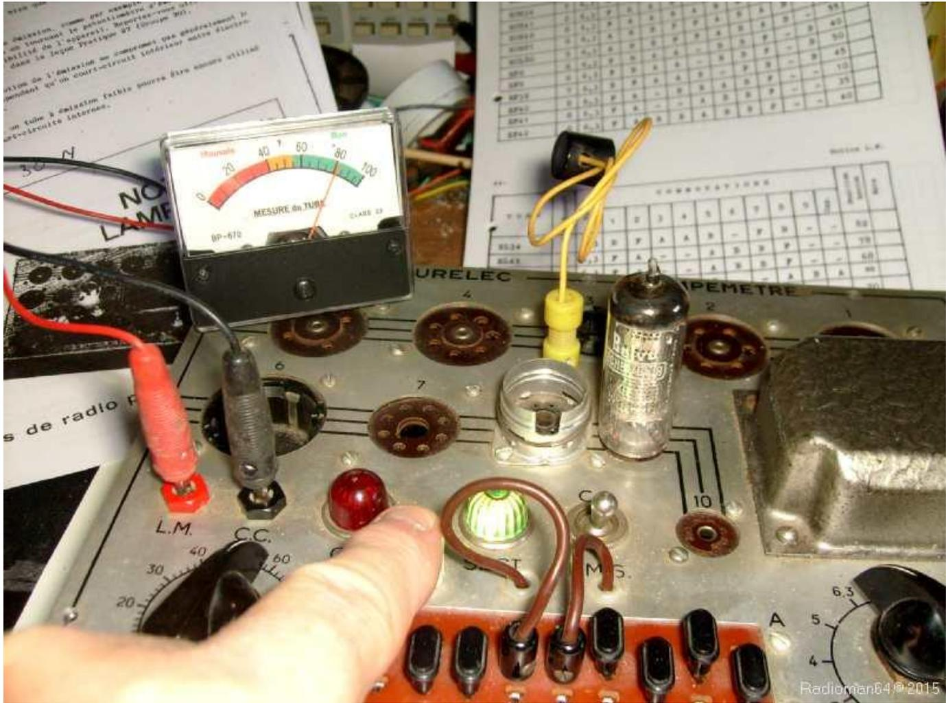
J'ai ensuite fabriqué un petit cordon avec 2 clips et une fiche banane pour les contacts de grille ou d'anode sur le haut de certains tubes :
