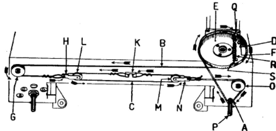
PER UNA SPIRA SULL'ALBERELLO DI COMANDO **P** E GIRANDO SOPRA LA PULEGGIA **E** INFILARLA NELLA FINESTRA **Q** FISSATO UN ESTREMO DELLA MOLLA **R** ALL'OCCHIELLO DELLA FUNICELLA SOPRADDETTA AGGANCIARE L'ALTRO ESTREMO DELLA MOLLA **R** AL DENTELLO **S**.
