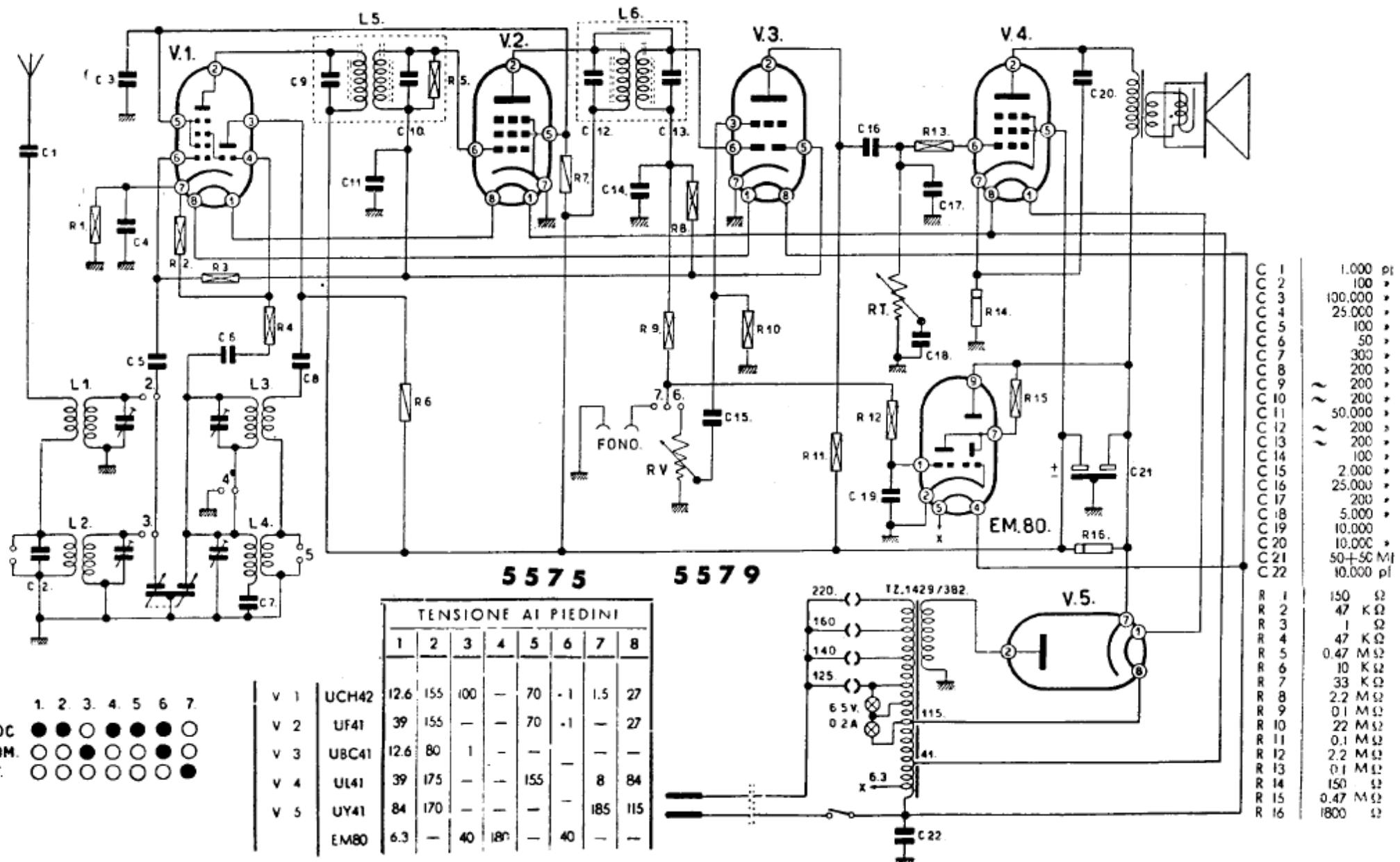
FIMI S.A. PHONOLA - Modd. 5575 e 5579 soprammobili. Una gamma onde medie da 185 a 576 m. Una gamma onde corte da 15,8 a 52 m. Media frequenza 470 kc/s. Potenza indistorta 3 watt. Consumo 37 watt. Il mod. 5575 differisce dal 5579 per il fatto di essere provvisto di controllo di tono, mentre il 5579 ha, nella medesima posizione, una resistenza di 0,22 megaohm.
