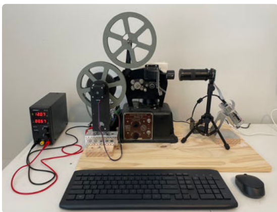
▲ Figure 3. Configuration d'un numériseur de film « maison ».
