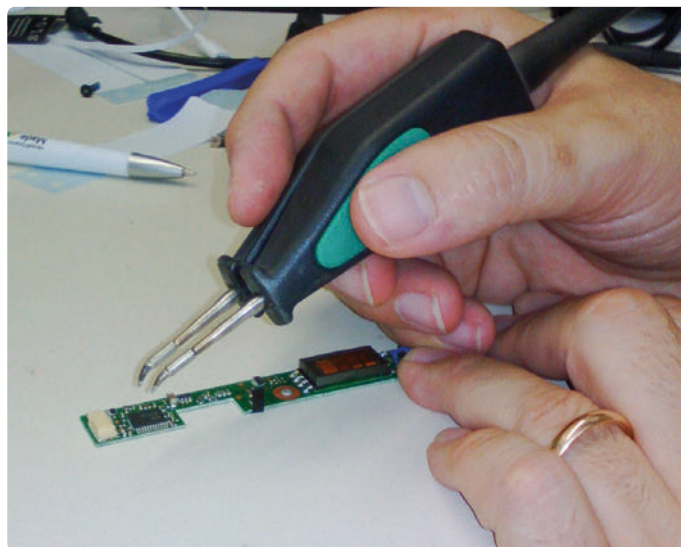
Figure 11. Dessoudage d'un composant à deux fils à l'aide d'une pince chauffante spéciale.
