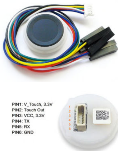
Figure 1. La face active du capteur (a) et le brochage du connecteur (b). (Source : Laboratoire de l'auteur)
