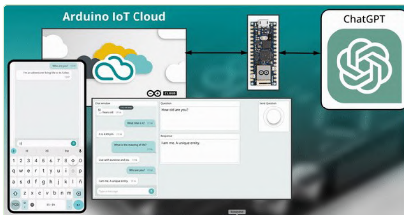
Figure 7. Carte Arduino intermédiaire entre ChatGPT et le Cloud IoT Arduino.
