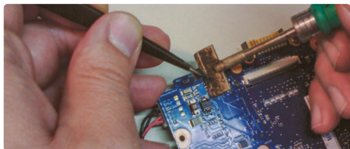
Figure 10. Dessoudage d'un chip TSSOP à l'aide d'une panne spécifique en forme de lame.
