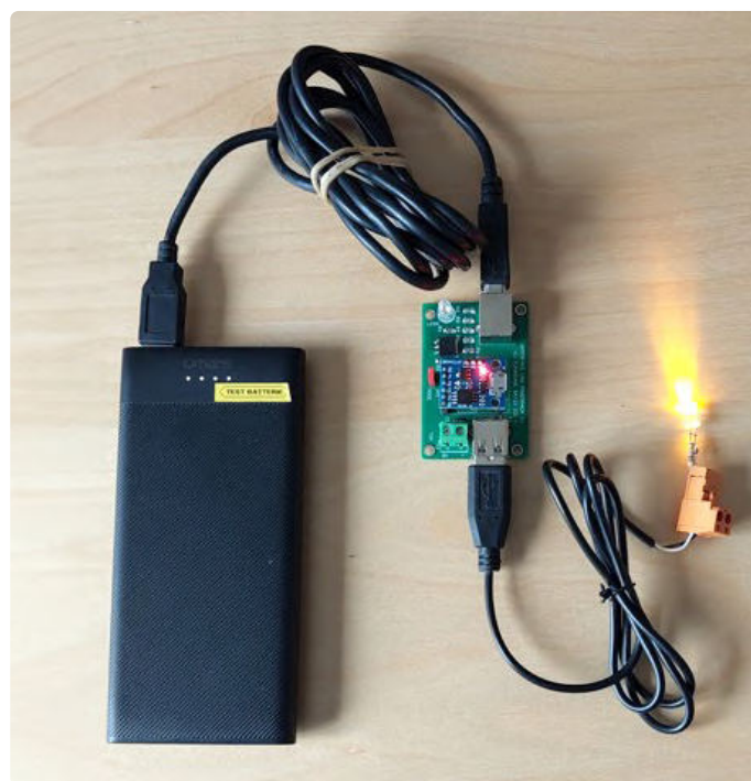
Figure 6. L'interface pour batterie externe USB en action.
