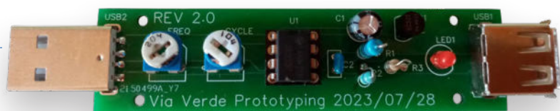
Figure 2. Circuit imprimé avec composants soudés
