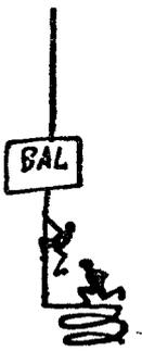
les électrons sont répartis également dans l'antenne (fig 31). Le courant alternatif les pousse tantôt au sommet de l'antenne (fig. 32), tantôt dans la terre (fig. 33).
