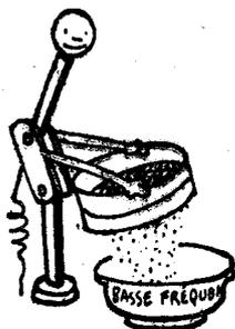
Avant la détection, nous avons du courant haute fréquence, après, du courant basse fréquence.
