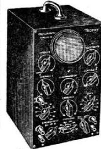
Synchronisation inférieure et extérieure. Tube cathodique Ø 75. Amplification horizontale et verticale. Synchronisation variable. Fréquence de 0 à 30 000 pps. Alimentation secteur 110 à 220 V. Dimensions : H. 300 L. 200, P. 330 mm
