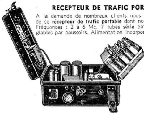
A la demande de nombreux clients nous venons de renouveler notre stock de ce récepteur de trafic portable dont nous rappelons les caractéristiques : Fréquences : 2 à 6 Mc. 7 tubes série batterie 1,5 V. 4 fréquences pré-régulables par poussoirs. Alimentation incorporée depuis une batterie extérieure. 6 ou 12 V. ou batterie intérieure 2 V. Recharge automatique par redresseur incorporé. Livré complet avec tubes.
