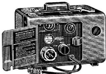
PPU permettant d'alimenter en HT à partir de 2 CV cont. un petit émetteur-récepteur fonctionnant sur pile 90/103 V. La batterie étant incorporée, la recharge peut s'effectuer à partir d'une batterie 6 ou 12 V extérieure. Livré avec ampèremètre de charge ou décharge, câbles et connecteur. Dim. av. poignée : L. 280 x larg. 160 x haut. 180 mm. Pour réemploi ou récupération de pièces. Valeur 600,00. **25,00**
