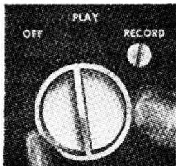
Fig. 4. — On aperçoit au-dessous du mot « Record » le bouton de sécurité permettant au bouton principal d'atteindre la position Enregistrement.
