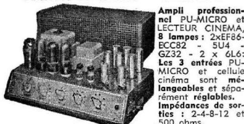
Ampli professionnel PU-MICRO et LECTEUR CINEMA, 8 lampes : 2xEF86-ECC82 - 5U4 - GZ32 - 2 x 6L6. Les 3 entrées PU-MICRO et cellule cinéma sont mélangeables et séparément réglables. Impédances de sorties : 2-4-8-12 et 500 ohms.
