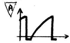
elles évitent une remontée de sous-porteuse. T36 bloqué; on a D47I conductrice (17 V en  $U_c$  de T36). LA RI étant parcourue par un courant, C se charge jusqu'à environ 17 V; puis il se décharge dans RI et maintient ainsi par le jeu de conduction la diode les 17 V: il y a donc écrêtage de la sous-porteuse, ce qui évite un basculement intempestif.
