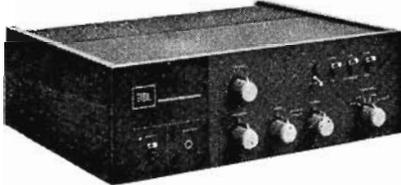
AMPLI-PREAMPLI stéréo entièrement transistorisé • Circuit en T • Puissance 2 x 60 W à - de 0,2% harmonique entre 20 et 20 000 Hz • Système «Aural Null Stereo Balancing» système de mise à 0 permettant un ajustage d'équilibre des 2 voies • 3 positions de sensibilité à l'entrée phono-captur • Double potentiomètre • 37 transistors • 23 diodes • Automatiquement protégé contre les court-circuits • Dimensions 41 x 13 x 35,6 cm.
