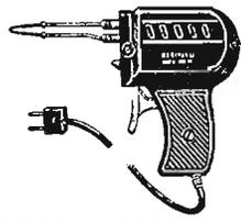
panne recevant : 0,5 V sous une très grande intensité, chauffage en quelques secondes, lampe directive éclairant la pièce à souder.
