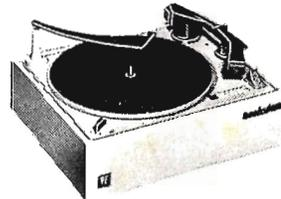
Changeur automat. monté sur socle, 16, 33, 45, 78 t., passe les disques tous diamètres (16 à 30 cm) dans n'importe quel ordre consécutif (dans une même vitesse), plateau lourd 268 mm, bras avec cellule magnét. stéréo SHURE M7DM, préampli magnét. incorporé, moteur 110/220 V - larg. 365, prof. 307, haut. 185 mm - livré avec cordon secteur et liaison BF (prise DIN 3 br.), axes changeurs 33 et 45 t. .... **349,00**
