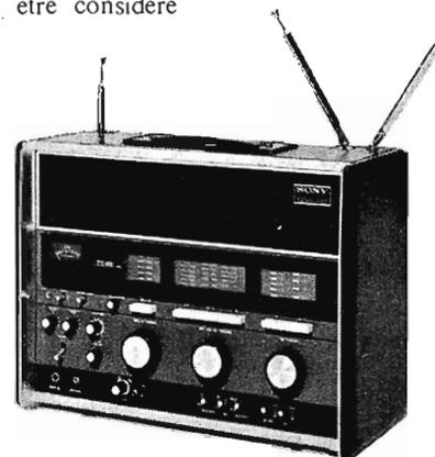
à juste titre comme un récepteur de trafic de très grande classe. Le « World Zone » reçoit les gammes PO, GO et OC1 (1,6-2,2 MHz) sur cadre ferrite incorporé et les gammes FM et OC2 à OC19 sur antenne télescopique incorporée.
