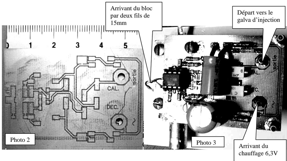
Bien entendu le bloc thermocouple reprend sa place avec ses deux vis de fixation au support stéatite supérieur. La dernière opération consiste au soudage au gros fer du ruban de cuivre ( point S ) à la borne d'injection. La **photo 4** donne l'aspect après réparation. Attention le 6,3Veff ( chauffage ) est pris sur le transformateur d'alimentation sur le gros fil toilé blanc et au retour masse châssis du transformateur.
