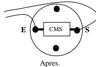
Les deux fils allant aux galvanomètre du thermocouple sont soudés aux bornes de la CMS en repérant le coté E arrivant du générateur (coté de la prise BNC ). Ils serviront d'entrée au système de remplacement.
