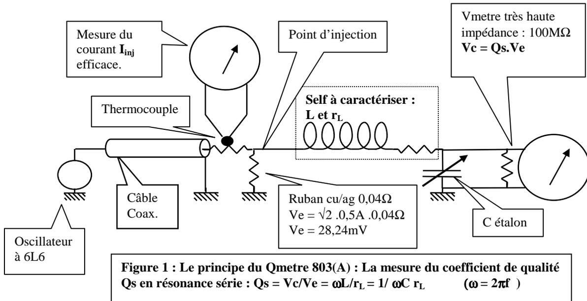
La source de tension de Thevenin ( **quasi parfaite :  $r_g = 40m\Omega$**  ) étant ajustée à 28mV, grâce au galvanomètre d'injection (  $I_{inj}$  ), il suffit de lire  $Q_s$  sur le voltmètre directement gradué en  $Q_s$ . Des points de fréquence clairement indiqués sur chaque gamme donnent lecture directe de la valeur de L, depuis **20nH jusqu'à 200mH !**
