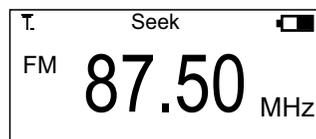
C'est l'écran par défaut en mode FM. Cet écran affiche la puissance du signal, la fréquence, le mode, le niveau de la batterie et des informations RDS.
