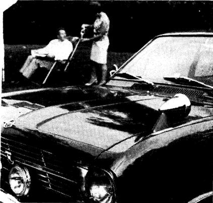
Nouvelle antenne AM/FM de voiture, type « Alpha 3 », de conception très originale, enfermée dans le support d'un rétroviseur d'ailé. Elle comprend un certain nombre de circuits et un amplificateur à transistors dont la consommation n'excède pas 10 mA (FUBA).
