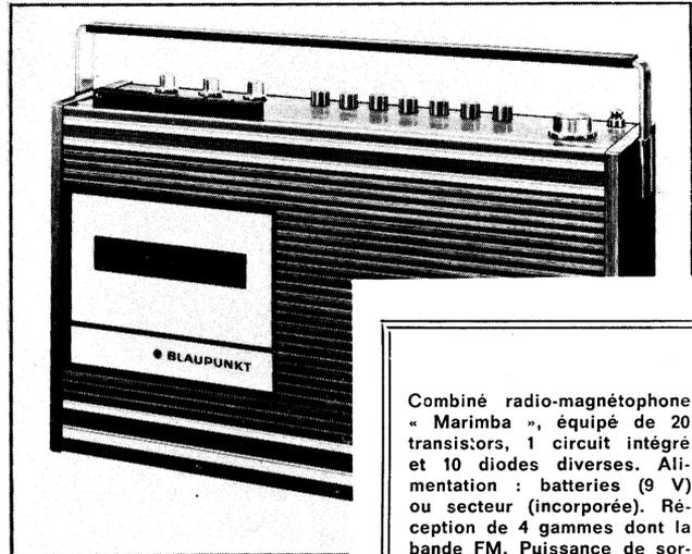
Combiné radio-magnétophone « Marimba », équipé de 20 transistors, 1 circuit intégré et 10 diodes diverses. Alimentation : batteries (9 V) ou secteur (incorporée). Réception de 4 gammes dont la bande FM. Puissance de sortie : 2 W, sur H.P. de 130 millimètres. Réglage de tonalité séparé pour graves et aigus. Moteur d'entraînement à stabilisation électronique de vitesse. Dimensions : 364 x 218 x 102 mm (BLAUPUNKT).
