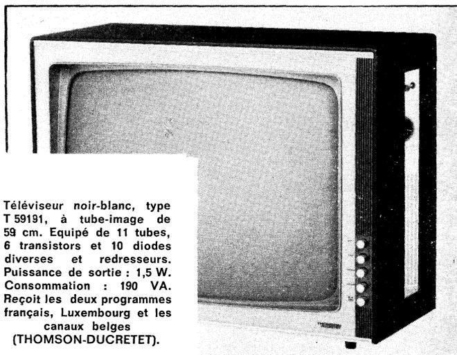
Téléviseur noir-blanc, type T 59191, à tube-image de 59 cm. Equipé de 11 tubes, 6 transistors et 10 diodes diverses et redresseurs. Puissance de sortie : 1,5 W. Consommation : 190 VA. Reçoit les deux programmes français, Luxembourg et les canaux belges (THOMSON-DUCRETET).
