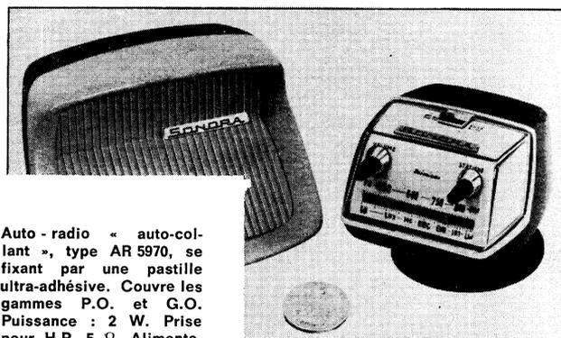
Auto-radio « auto-collant », type AR 5970, se fixant par une pastille ultra-adhésive. Couvre les gammes P.O. et G.O. Puissance : 2 W. Prise pour H.P. 5 Ω. Alimentation : 12 V (SONORA).
