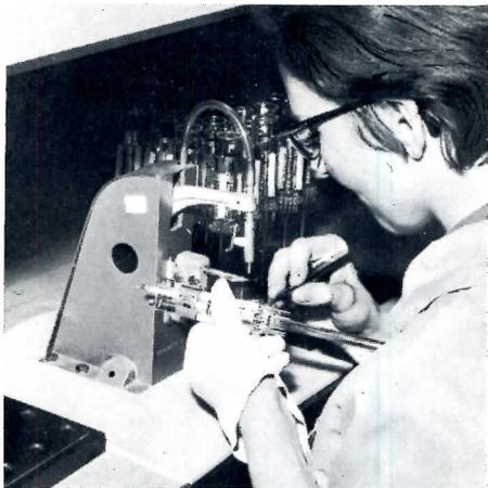
sent les opérations les plus délicates de la technologie électronique. Dans les ateliers de fabrication des écrans et des masques, l'air est climatisé et rigoureusement dépoussiéré; les opérateurs ou les opératrices travaillent en gants blancs, portent des cache-chaussures, ressemblent à des chi-
