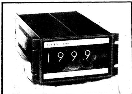
Indicateur numérique « Digitab », type TE 340, à 3 digits et entrée polarisée. Au choix : 5 gammes de tensions continues (199,9 mV à 999 V) ou 7 gammes de courant continu (199,9 nA à 199,9 mA). Dimensions : 64 x 128 x 190,5 mm. Poids : 720 g. Peut être muni de sorties numériques BCD 1-2-4-8 et d'un déclenchement à distance (TEKELEC - AIRTRONIC, Cité des Bruyères, rue Carle-Verne, 92-Sevres).
