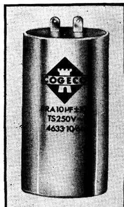
Condensateurs de la série PRA, au papier imprégné au pyralène pour le démarrage et la compensation des moteurs monophasés, le filtrage des régulateurs de tension à fer saturé, etc. Valeurs : 0,3 à 25  $\mu$ F. Tension de service : 250 à 600 V. Boîtiers : 9 hauteurs associées à 7 diamètres (COGECO, 21, rue de Javel, Paris-15<sup>e</sup>).
