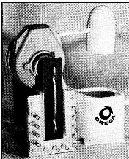
Ce transformateur T.H.T. universel, type 3016, à haute impédance, est prévu pour le remplacement de tous les modèles dits de « haute impédance », sur tous les téléviseurs équipés de tubes de 70°, 90°, 110° et 114°. Utilisé avec le support 40673 il permet le remplacement de tous les modèles existant sur le marché. Plusieurs prises permettent d'adapter son impédance à tous les cas que l'on peut rencontrer (OREGA).
