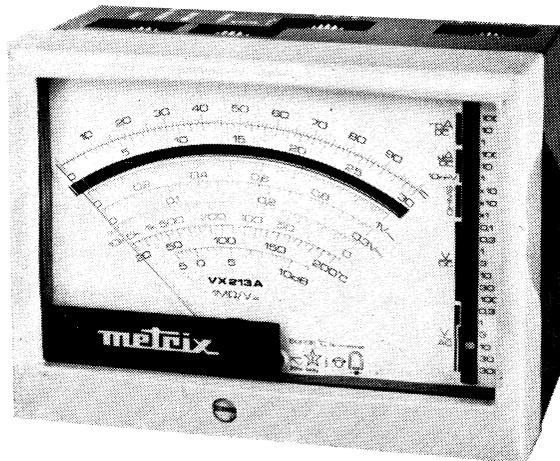
résistances, les températures (avec adjonction d'un thermocouple), les décibels (échelle de référence : 0 dB = 1 mW/600 Ω), les éclaircissements.
