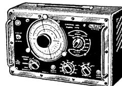
9 gammes HF de 100 kHz à 225 MHz. Sans trou - Précision d'étalonnage ± 1 % Ce générateur de fabrication extrêmement soignée, est utilisable pour tous travaux, aussi bien en AM qu'en FM et en TV, ainsi qu'en BF. Il s'agit d'un modèle universel dont aucun technicien ne saurait se passer. Dimensions : 330 x 220 x 150 mm. Notice complète contre 0,50 NF en T.-P. Prix .. **522,00****CRÉDIT**6 - 12 MOIS
