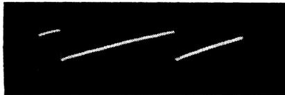
Fig. 33. — Dent de scie à la base de l'enroulement grille du transformateur blocking.
