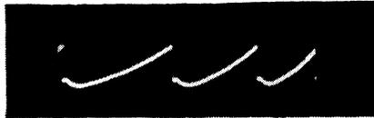
Fig. 34. — A la grille du tube final images on trouve une dent de scie légèrement (et intentionnellement) déformée.
