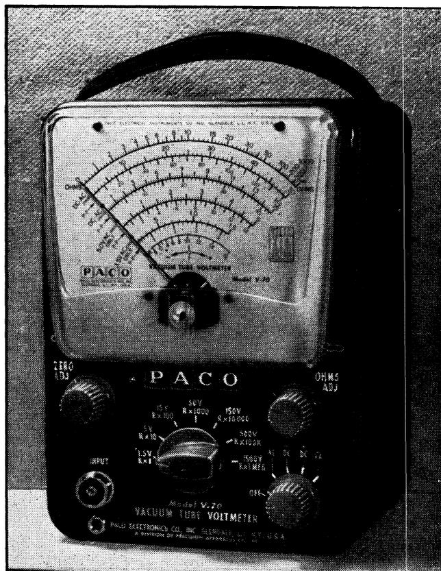
tiomètre ajustable  $R_4$  de façon à amener l'aiguille exactement sur la graduation 124 V. **Mais attention !** Pendant cette opération le châssis de l'appareil peut se trouver relié à un fil « actif » du secteur, ce qui, dans certaines conditions défavorables, peut présenter un réel danger. Donc, prudence.
