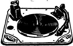
**RC88** - Changeur autom., 4 vitesses, pour 8 disques avec levier sélecteur. Utilisable en T.D. à commande manuelle. Moteur altern. 110 à 220 V. Haut. 247, long. 394, prof. 337. Avec tête cristal GC8.
