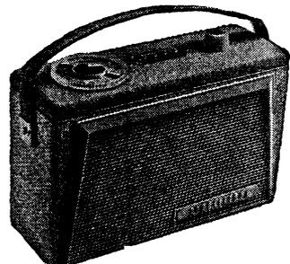
**ONDINE :** Présentation : très beau coffret gainé deux tons, coloris mode. **Caractéristiques :** PO-GO, antenne commutable, sortie BF en Classe A glissante, six transistors, deux diodes. Haut-parleur soucoupe 127 mm, haute impédance. **Prix absolument complet en pièces détachées .. 159,94 NF**
