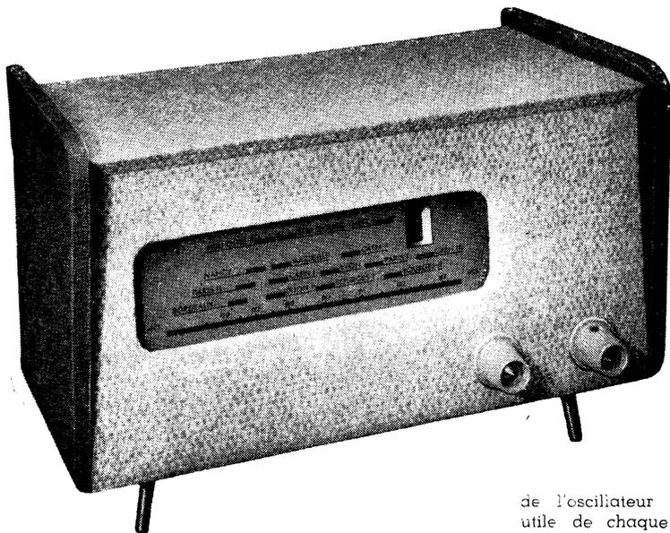
L'appareil décrit aujourd'hui est un tuner FM et n'est que cela. En d'autres termes, il ne s'agit pas ici d'un tuner dit mixte, AM/FM, mais d'un ensemble prévu pour recevoir uniquement les émissions modulées en fréquence et pour attaquer la prise P.U. d'un récepteur radio normal.
