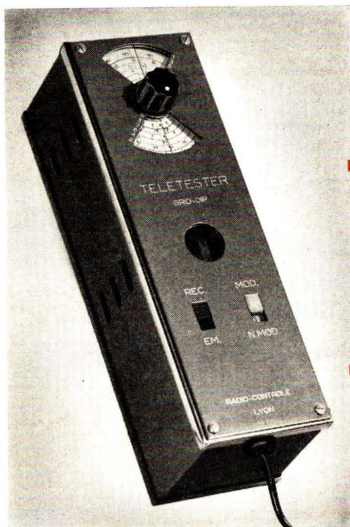
Grid dip « Tététester » Radio-Contrôle permettant la recherche et la localisation facile des pannes dans un téléviseur : mesure de la fréquence d'un oscillateur ; mesure d'une fréquence d'accord ; utilisation en générateur H.F. et V.H.F. modulé.
