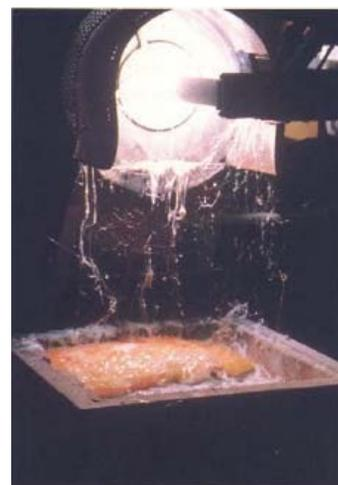
Photographie d'une coulée d'alumine électrofondue.
