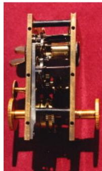
Régulateur "Serrin" constitué d'un mouvement d'horlogerie permettant mécaniquement le rapprochement des deux charbons.
