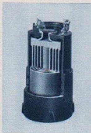
*Vue en coupe d'un trimmer, condensateur de réglage d'une technique raffinée.*
