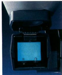
ein Druck auf die Record/Review-Taste an der Kamera. Der Beta-max-SL-F1E spult dann 2 sec. mit sichtbarem Bild zurück und gibt diese Szene über den Sucher-Monitor wieder.
