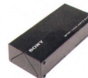
BCA 80. Der Akku-Ladeadapter für NP 22, lädt einen Akku mit ACP 88E in 1,5 Std. oder lädt ein bis drei Akkus mit ACP 88E gleichzeitig in ca. 8-10 Std.
