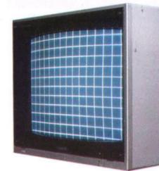
Nur soviel zur Trinitron-Farbbildröhre. Damit Sie wissen, warum das Sony Farbfemseh-Bild, verglichen mit anderen, einen gewissen eigenen Charakter hat. Schon auf den ersten Blick zu erkennen – der Bildschirm eines Sony Trinitron ist auffallend flach. Und in den Bild-Ecken nahezu rechteckig. Der Grund: Der Bildschirm der Trinitron-Röhre ist nur zylindrisch, also horizontal gekrümmt. Drum zeigt das Bild auch an den Seiten nahezu keine
